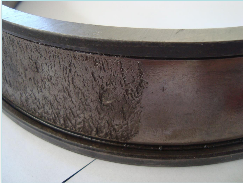
Análise de falha em pista interna de rolamento
