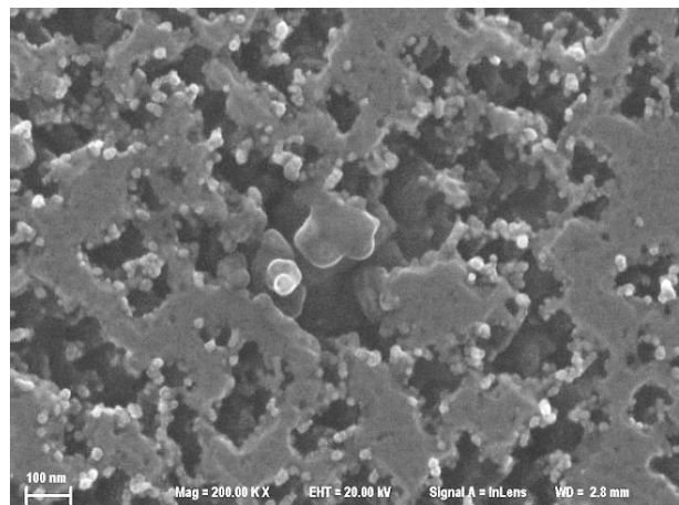
Fig. 3 – Precipitados na liga de Alumínio 7075-T6.
