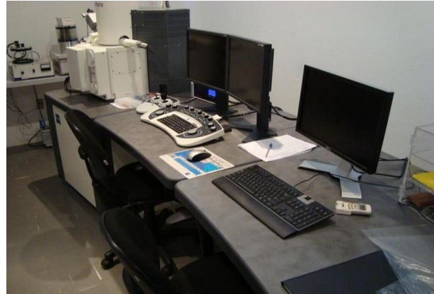
Fig. 2 – Microscópio eletrônico de varredura de alta resolução do tipo FEG – Field Emission Gun.
